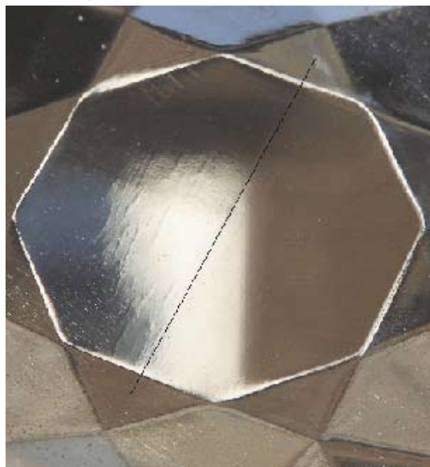
Rechte Hälfte wurde nach reklamierter „Orangenhaut“ nach poliert.
